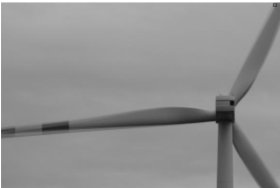
Bild 1: Monochrome Aufnahme eines Rotorblattes mit sichtbarer Bewegungsunschärfe
