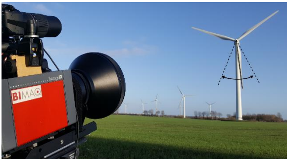
Abbildung 1: Thermografische Strömungsvizualisierung an einer WEA in Betrieb
