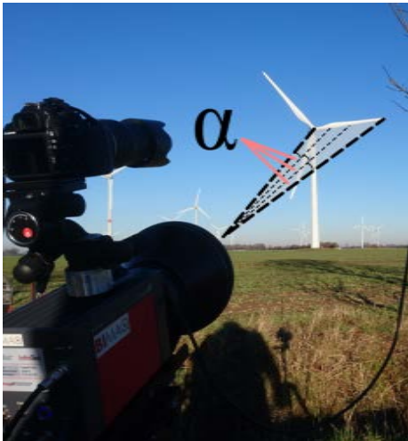
Bild 1: Kamerasystem mit abschnittsweiser Winkelbewegung
