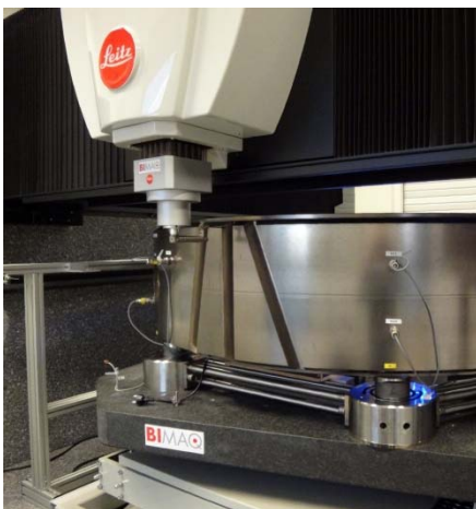
Bild 2: Messung des weltweit größten Verzahnungsnormals auf dem Groß-KMG des BIMAQ.
