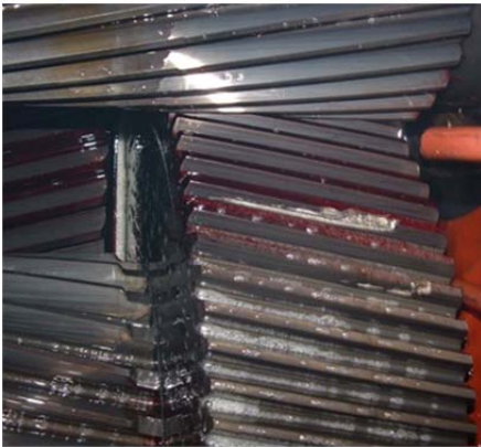
Bild 1: Beschädigte Verzahnung (Quelle: www.sonnenwindwaerme.de )
